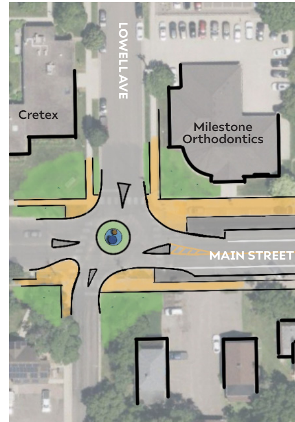
Main St & Lowell Ave Mini Roundabout
