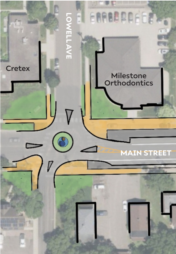
Main St & Lowell Ave Mini Roundabout
